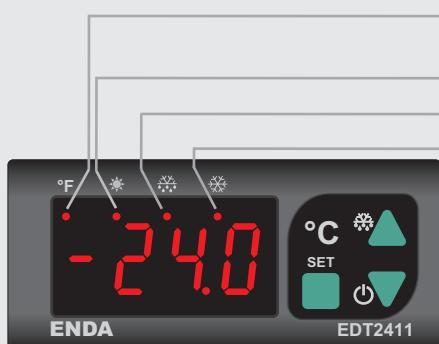
**°F FAHRENHAYT LED'İ:** Parametre değerinde veya ölçülen sıcaklık değeri °F biriminde ise yanar. Gizli menüde ,aynı zamanda kullanıcı menüsündede bulunan bir parametre gösteriliyorsa bu LED yanar.
